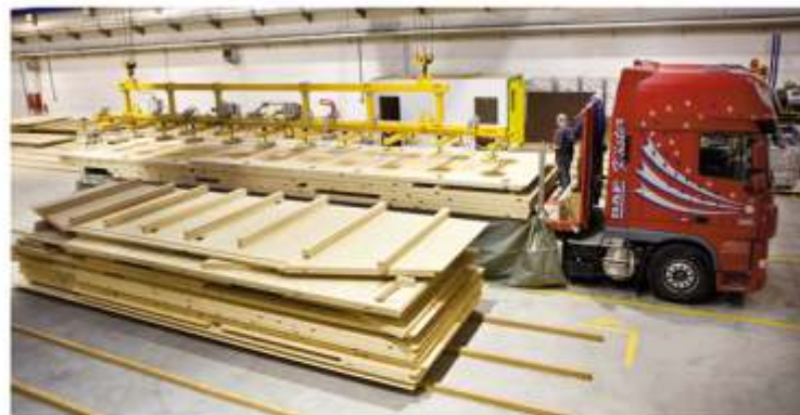
en gennemtænkt stablings rækkefølge muliggør den hurtige montering
